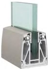
Typ B zur aufgesetzten Montage. Die Fußanker werden auf einer Bodenschiene montiert. Geeignet für den Einsatz von Sicherheitsglas in einer Stärke von 16mm oder 20mm. Die Abdeckung erfolgt mit einer Aluminiumprofilleiste.
