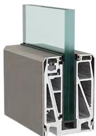
Klemmfüße aus Aluminium werden auf dem Boden aufgeschraubt. Geeignet für eine Glasstärke von 16mm und 20mm. Die Abdeckung erfolgt mit einer Aluminiumprofilleiste.
