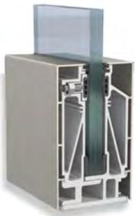
Typ E zur aufgesetzten Montage. Anbringungen der Klemmfüße auf einer Bodenschiene. Verschiedene Glasstärken sind möglich (16mm, 20mm und 24mm). Glasscheiben bis zur einer Höhe von 1200mm einsetzbar.
